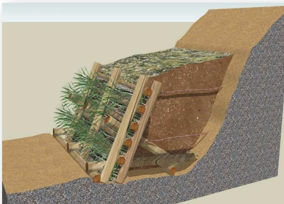
*Figura 5 - Spaccato assonometrico di una palificata doppia*
